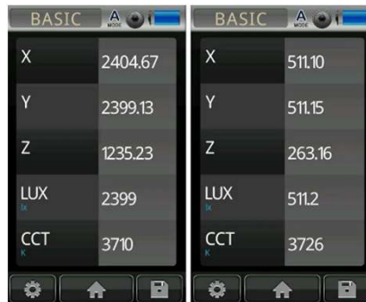
Fig. 10: La pantalla izquierda está muy cerca de la luz, la pantalla derecha está más lejos. Observe cómo cambian los valores XYZ, pero la distancia aún no es importante porque las proporciones son las mismas.
