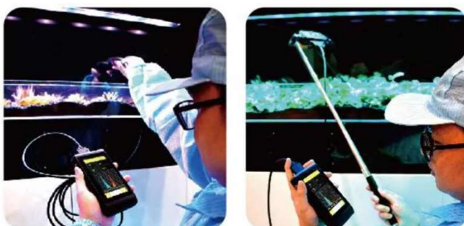
Figura 5 Medición de PPF con un medidor PAR
